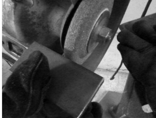
**FIGURA 5.5. GARGANTA EN LOS REFUERZOS DE SOLDADURA.**
