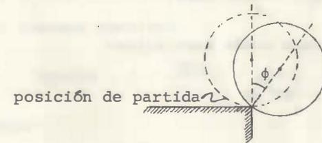
Solución.- La esfera realizará un movimiento de rotación no baricéntrica, en torno a un eje (perpendicular al plano de movimiento) que pasa por el punto de contacto con el borde, en tanto no salga despedida.
