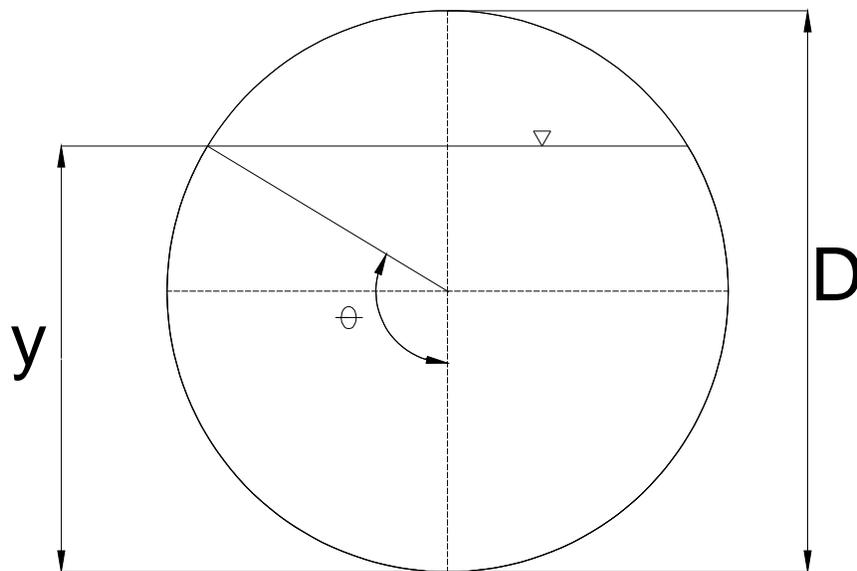
**Figura 5.1. Elementos geométricos de un canal de sección circular.**
