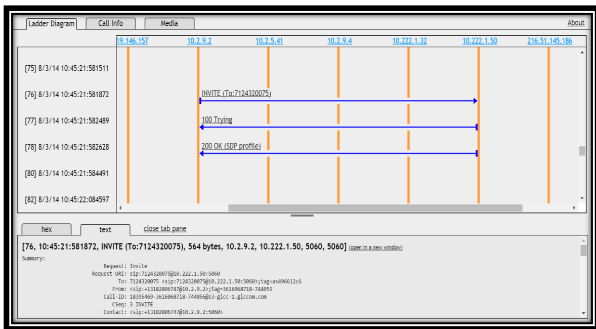
Figura 3.2 Diagrama de escalera mostrando el problema
