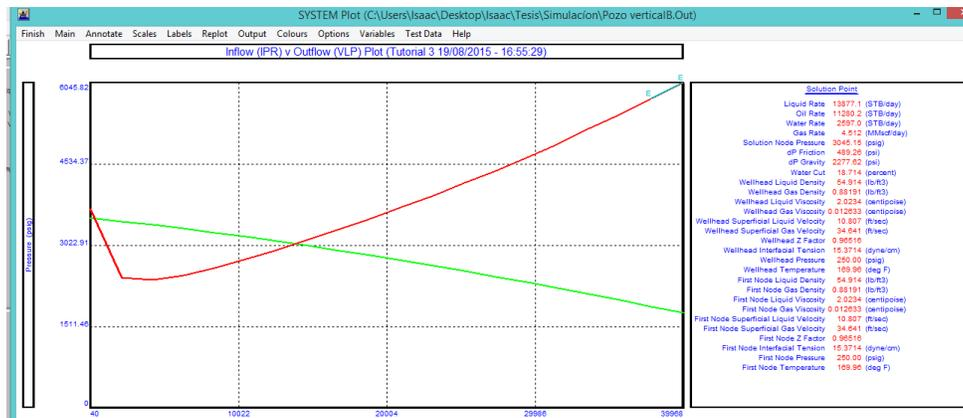
Fig. 79 El simulador gráfica la curva de comportamiento de afluencia y la curva de capacidad de transporte.
