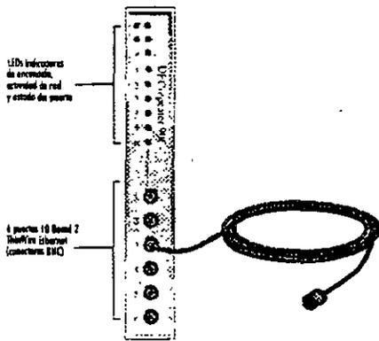
**DECrepeater 90C** admite hasta 185 metros de cable ThinWire para cada uno de los seis puertos. Identifica y aísla automáticamente los puertos defectuosos.
