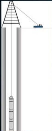
Esquemático de una toma de registros en un pozo
