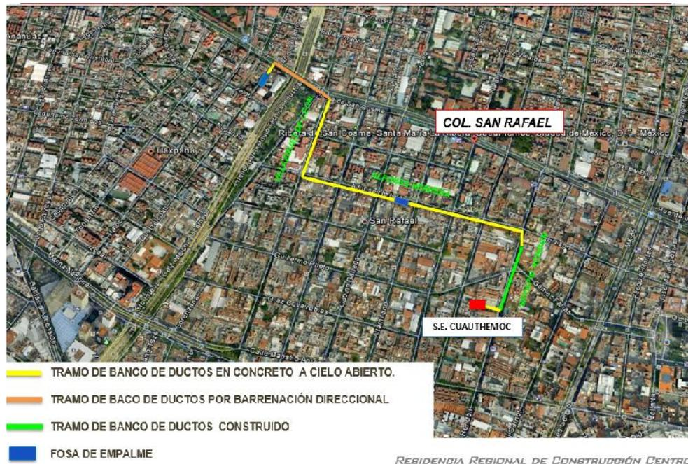
Figura 4.4.- Trayectoria de L.T. Cuauhtémoc – Verónica 230 kV.
