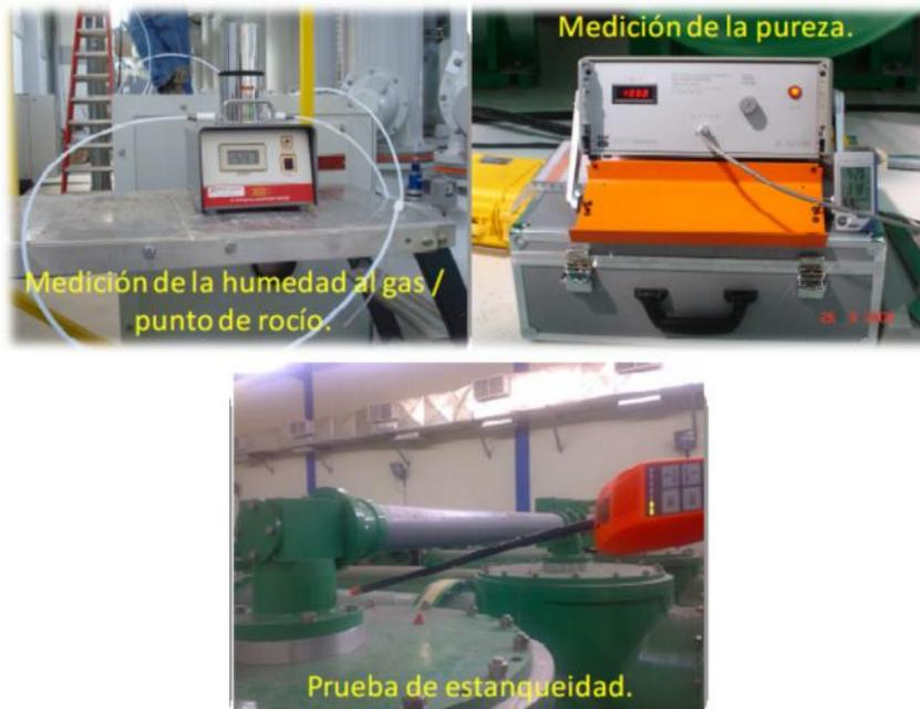
Figura 5.26 - 5.27 - 5.28.- Pruebas al Gas SF<sub>6</sub>
