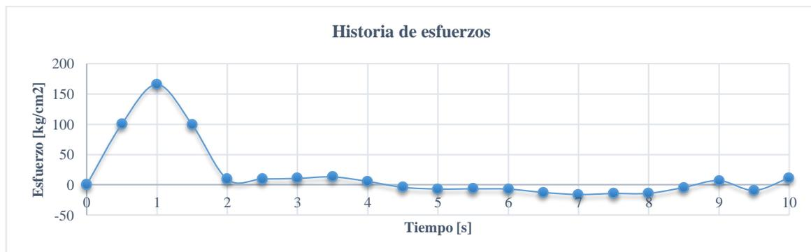
Ya que el punto **a** de análisis de la viga se encuentra a 54.5 cm del eje neutro, mediante una relación de triángulos se puede determinar el esfuerzo en este punto como se puede observar en la **figura 7.1** para cada caso de rango de esfuerzo. Se utiliza la ayuda del software JRAIN, para la realización del conteo de ciclos de rangos de esfuerzos.
