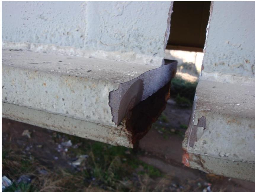
**Figura 1.2** Fractura por fatiga [web]
