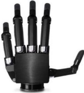
Tiene 6 motores CD acoplados por tornillos sin fin a mecanismos de 4 barras, 2 motores para el pulgar y 1 más para cada uno de los otros dedos. Cada dedo puede alcanzar una fuerza en la punta de 8.44 [N] y el peso aproximado de cada dedo es de 37 [g].
