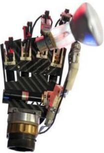
Tiene 6 motores CD, 2 para el pulgar y uno para cada uno de los otros dedos. Tiene un mecanismo de 6 barras y caja reductora de engranes con tornillos sin fin para conectar el motor y la caja. Cada dedo logra una fuerza máxima de 9.2 [N], su fuerza máxima de agarre de toda la prótesis es de 36 [N]. Pesa 400 [g] y acciona con comandos mioeléctricos.
