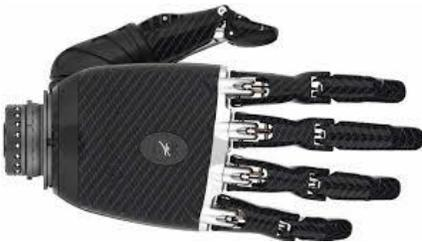
Tiene una fuerza máxima de agarre de 140 [N] logrado con 5 motores CD, cuenta con el sistema de transmisión diseñado exclusivamente por Ottobock y además los dedos funcionan con un mecanismo de 4 barras. Su peso ronda entre los 560 a 600 [g]. Con un precio de USD \$ 11,000
