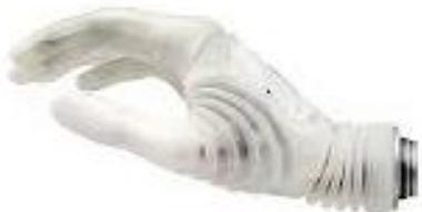
Tiene un peso aproximado entre los 460 y 510 [g]. Cuenta con una fuerza máxima de agarre de aproximadamente 70N que los logra con 2 motores DC. Usa un mecanismo de bielas para mover los dedos junto con una transmisión mediante un control mioeléctrico. Y su precio ronda entre los USD \$(73,000 – 120,000).
