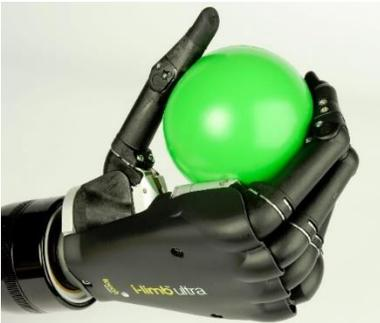
Cuenta con 5 motores CD, con una transmisión de tornillo sin fin a un mecanismo de 4 barras. Tiene una fuerza máxima de agarre de 136 [N] y la mano puede soportar una carga máxima de 90kg sobre ella, pesa 479g y tiene un precio entre USD \$ (60,000 – 120,000)
