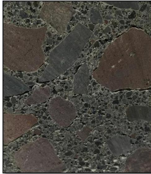
Figura 4. Falta de adherencia de los agregados y la pasta.
