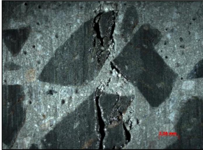
Figura 1. Agrietamiento por un esfuerzo excesivo en el elemento
