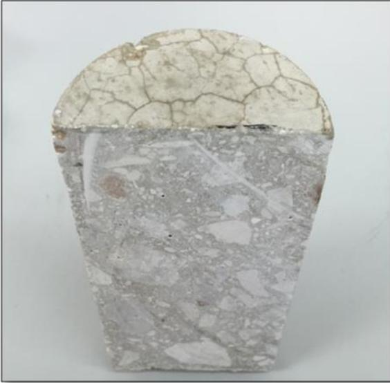
Figura 3. Agrietamiento superficial provocado por una pérdida acelerada de humedad
