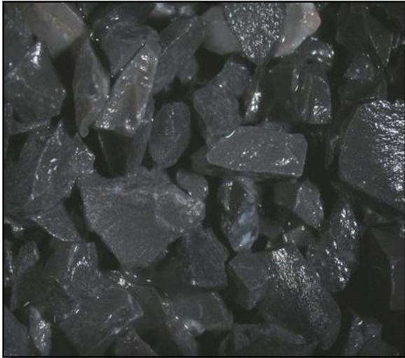
Figura 11. Muestra de agregado caliza vista con el microscopio estereoscópico.
