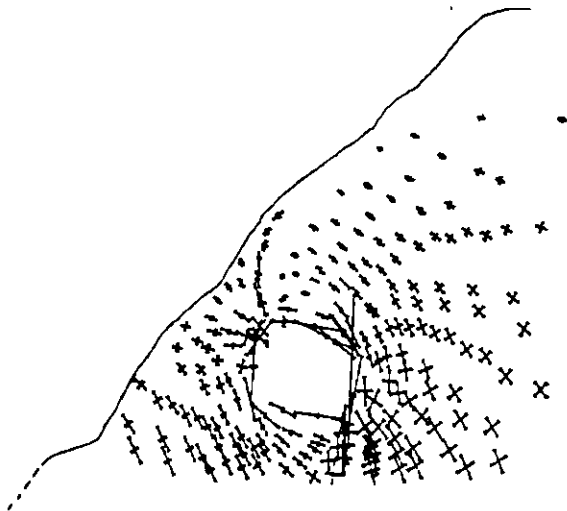
Esfuerzos Principales (al concluir la excavación completa)
