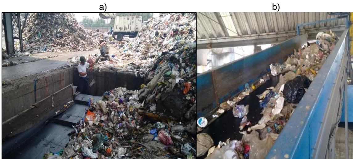
Figura 5.26 Fosa de depósito (a) y banda inicial de transporte de residuos (b)
