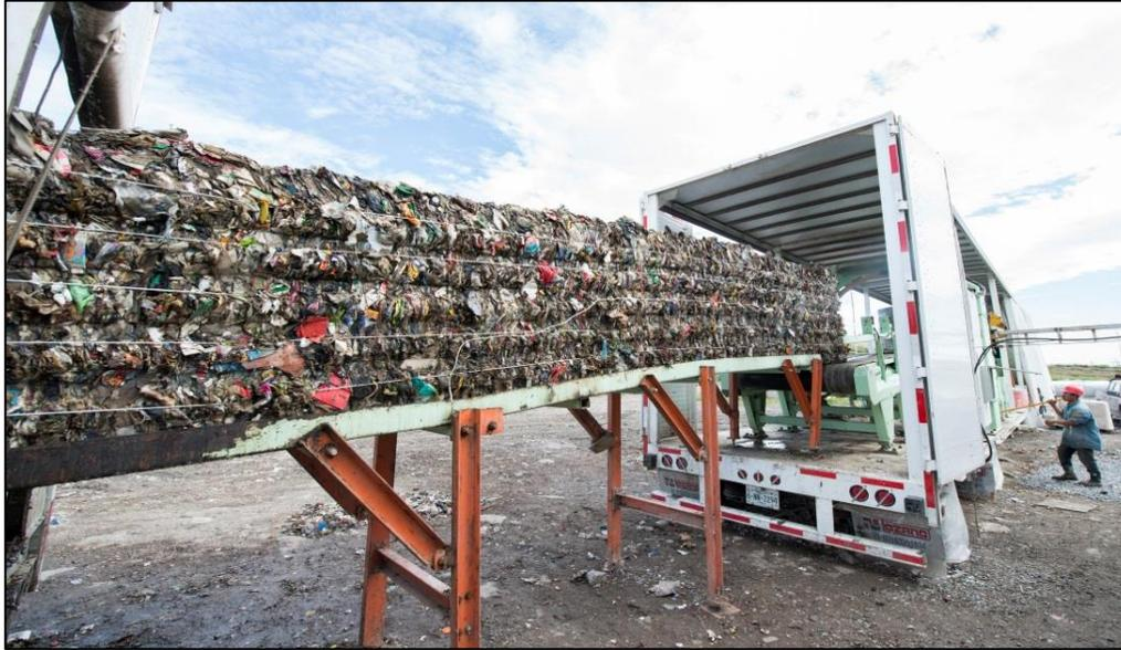
Figura 2.8 Compactación y atado de la FIRSU
