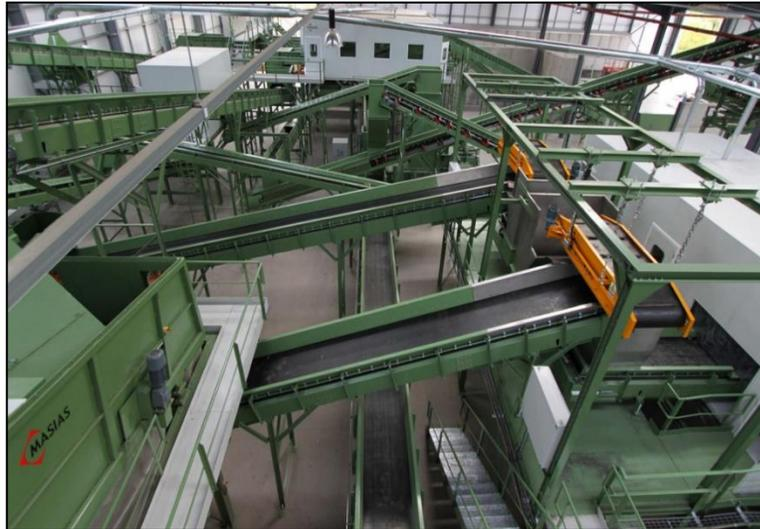
Figura 5.51 Separador magnético tipo Overband
