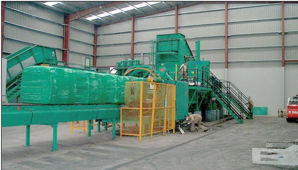
Figura 5.56 Instalación compuesta por una empacadora de caja cerrada y envolvente CW
