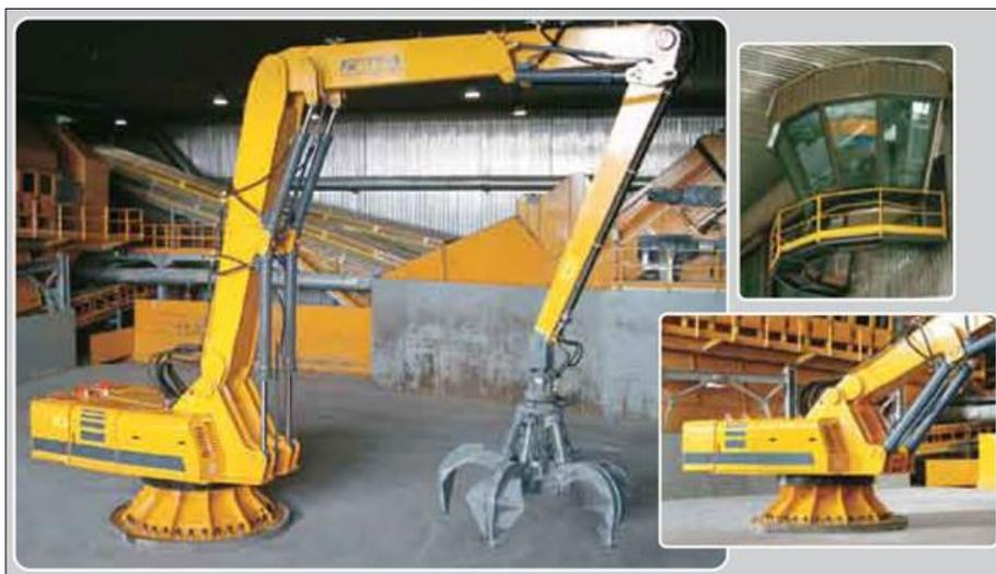
Figura 5.36 Grúa pedestal modelo COLMAR F63
