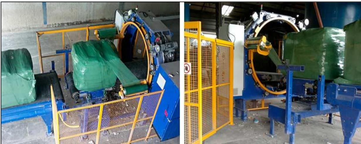
Figura 5.55 Envolvente de película extensible Cross Wrap-D-2200 LW750
