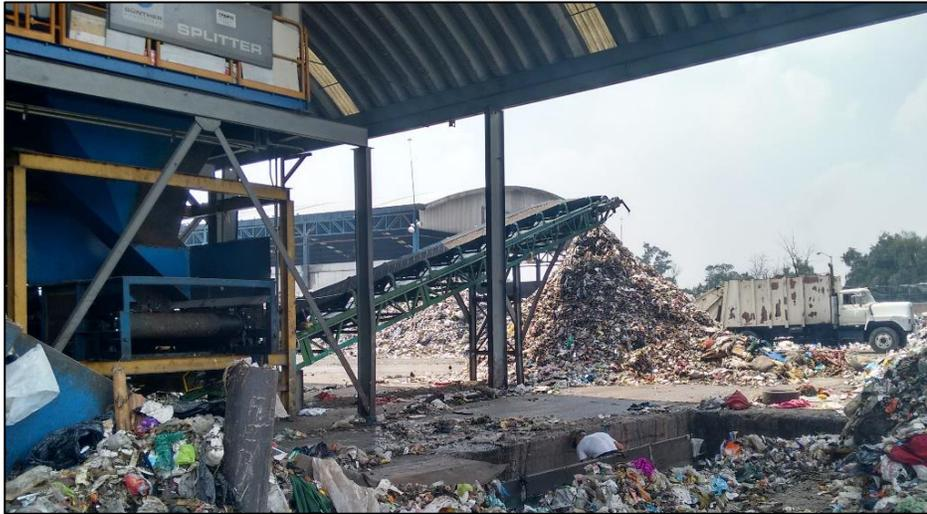
Figura 5.29 Separación de la materia orgánica por el separador tipo Splitter
