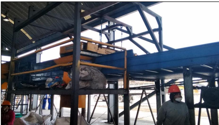
Figura 5.28 Separador magnético tipo Overband
