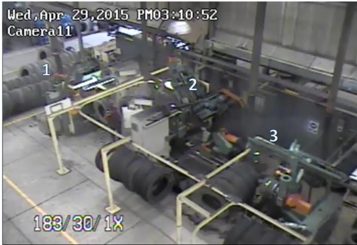
Figura 4.7. Proceso de raspado
