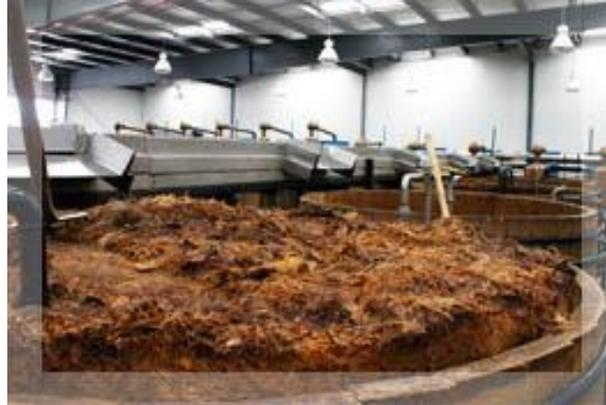
**Figura 2.4.** Extracción de azúcares (CRT, 2015)
