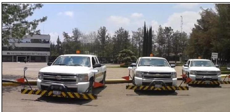
Figura 17. Equipos de medición para IRI y roderas.
