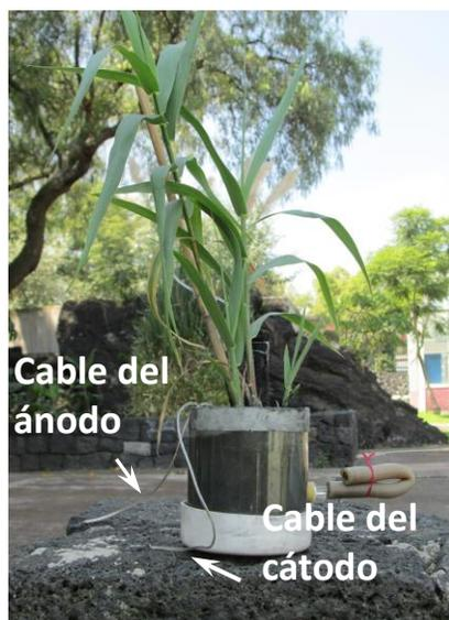
Figura 4.1a Conformación de la celda
