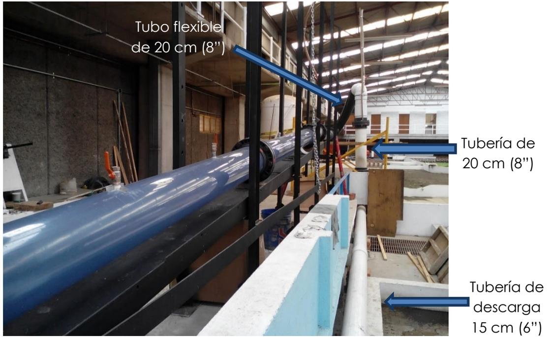
Figura 4. 5. Tubería de conducción
