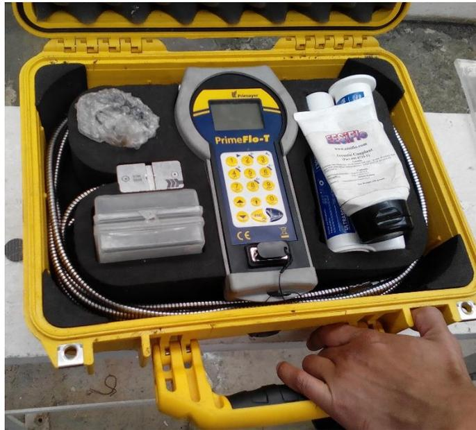
Figura 4. 13. Medidor de flujo ultrasónico
