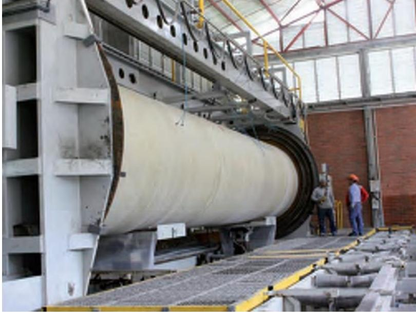
Figura 1. 12. Fabricación de tuberías de PRFV
