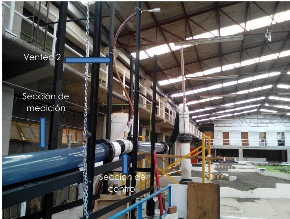
Figura 4. 7. Sección de control y de medición
