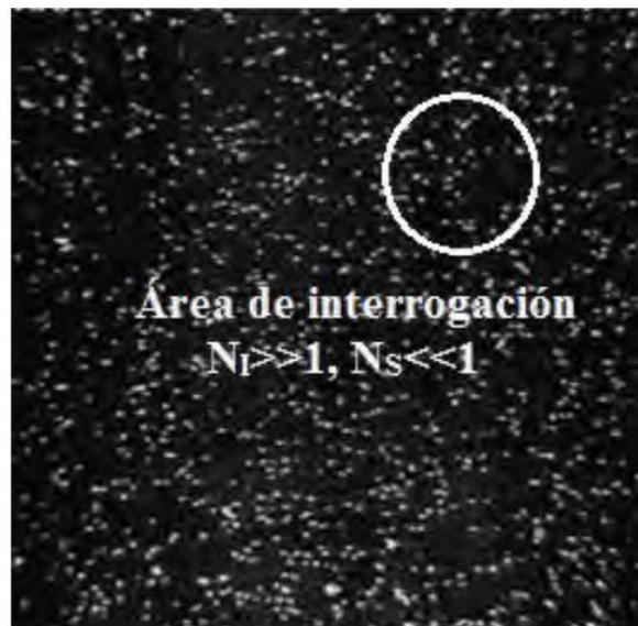
Figura 3. 7. Ejemplo de imagen obtenida con un sistema PIV
