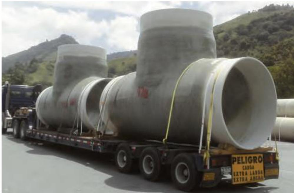
Figura 1. 27. Transporte de tee's de PRFV
