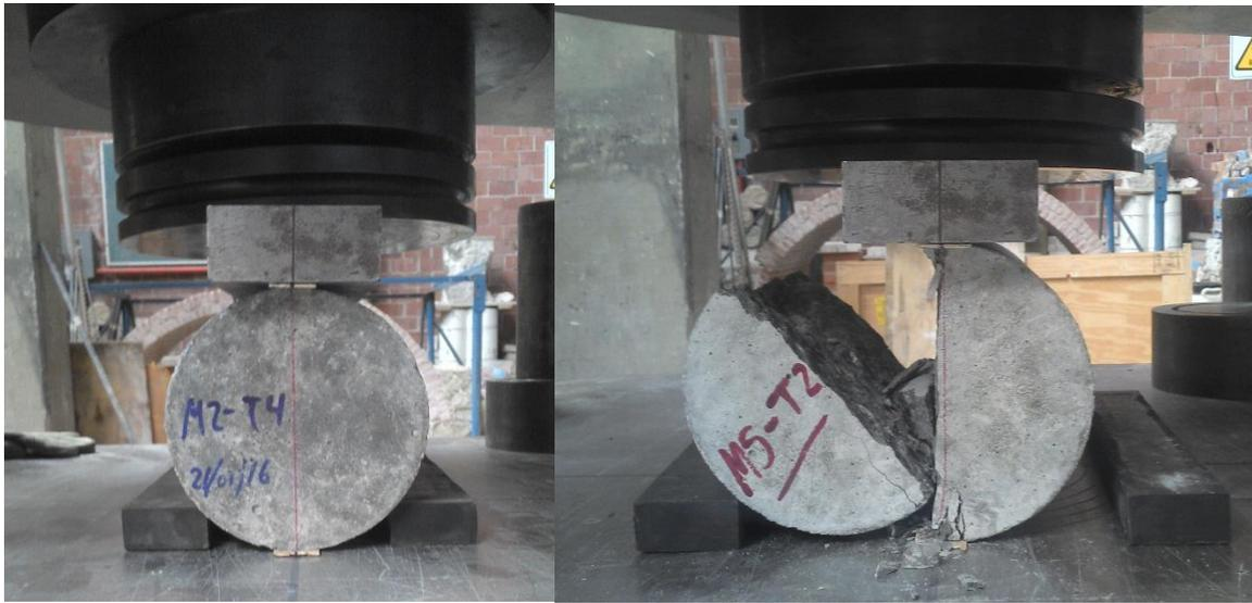
**Fig. 7** Configuración de la prueba de compresión diametral. *Imágenes propias de la investigación.*
