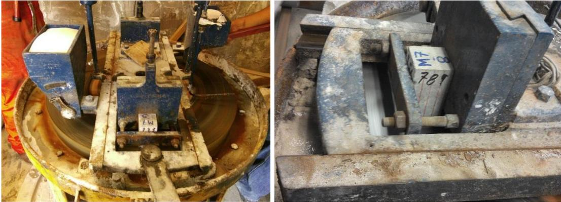
**Fig. 14** Colocación de especímenes de concreto en el disco giratorio para la prueba de abrasión. *Imágenes propias de la investigación.*
