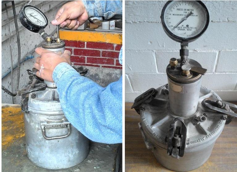
**Fig. 3** Equipo empleado para las pruebas de contenido de aire y peso volumétrico del concreto. *Imágenes producto de la Investigación.*
