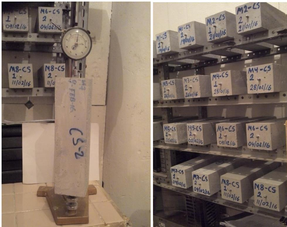
**Fig. 11** A la izquierda, comparador de longitudes utilizado para la toma de lecturas de las prueba de contracción por secado y ataque por sulfatos; a la derecha, especímenes prismáticos del estudio en la cámara seca. *Imágenes propias de la investigación.*
