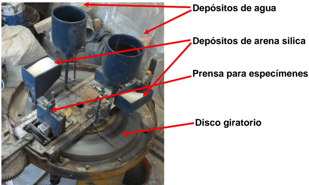
**Fig. 13** Máquina empleada en la prueba de abrasión de la norma NMX-C-008-1974. *Imagen propia de la investigación.*
