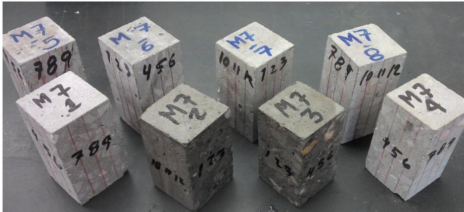
**Fig. 12** Especímenes utilizados para las pruebas de abrasión. *Imagen propia de la investigación.*
