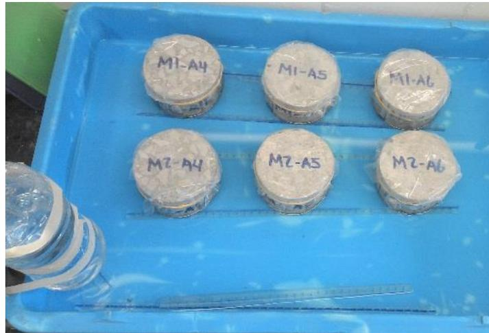
**Fig. 17** Especímenes en prueba de absorción capilar. *Imagen propia de la investigación.*
