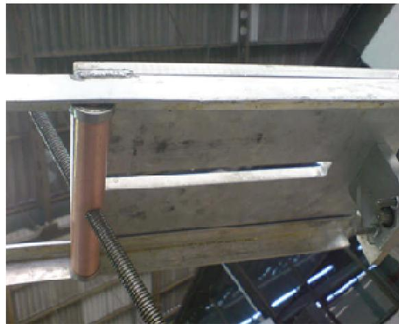
*Figura 60 Cilindro con rosca del tornillo sin fin.*
