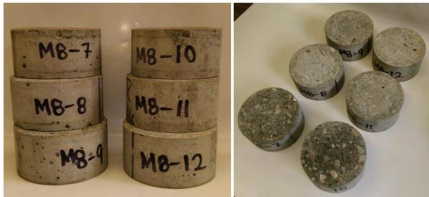
**Figura 3.11** Ejemplo de especímenes utilizados para el ERPC, se muestran los especímenes de la mezcla M8 (500 kg/m<sup>3</sup>, 10% de ceniza volante y 4.9% de aire incluido) para su ensaye a 91 días.
