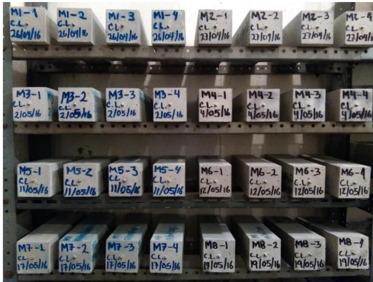
Figura 3.16 Especímenes fabricados almacenados en la cámara seca.
