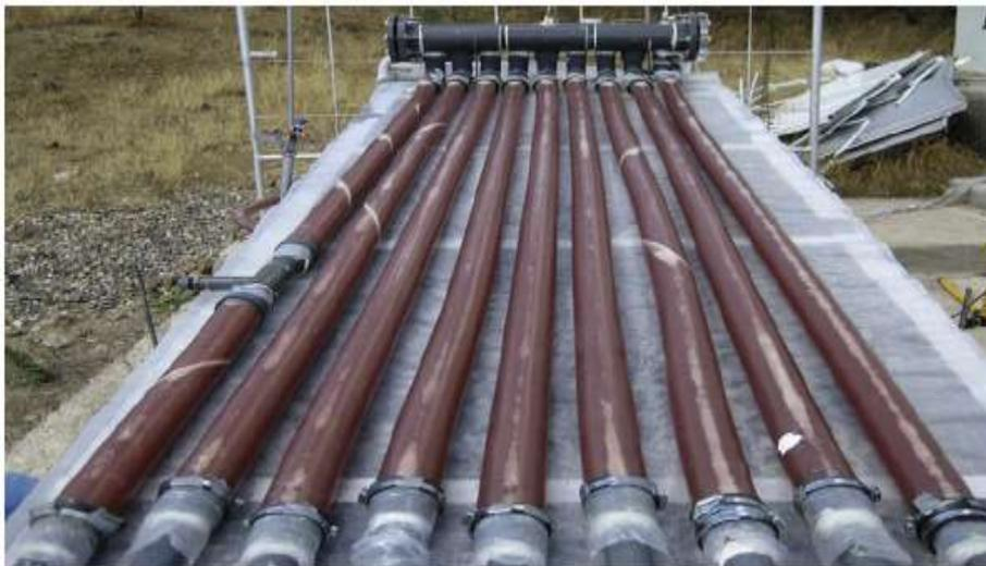
Figura 12. Ejemplo de un fotobiorreactor
