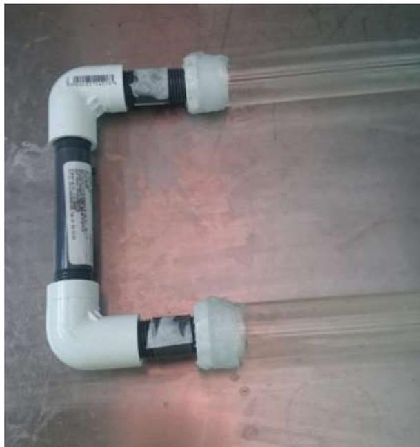
*Figura 15.* Muestra de uniones del tubo pyrex con coples PVC
