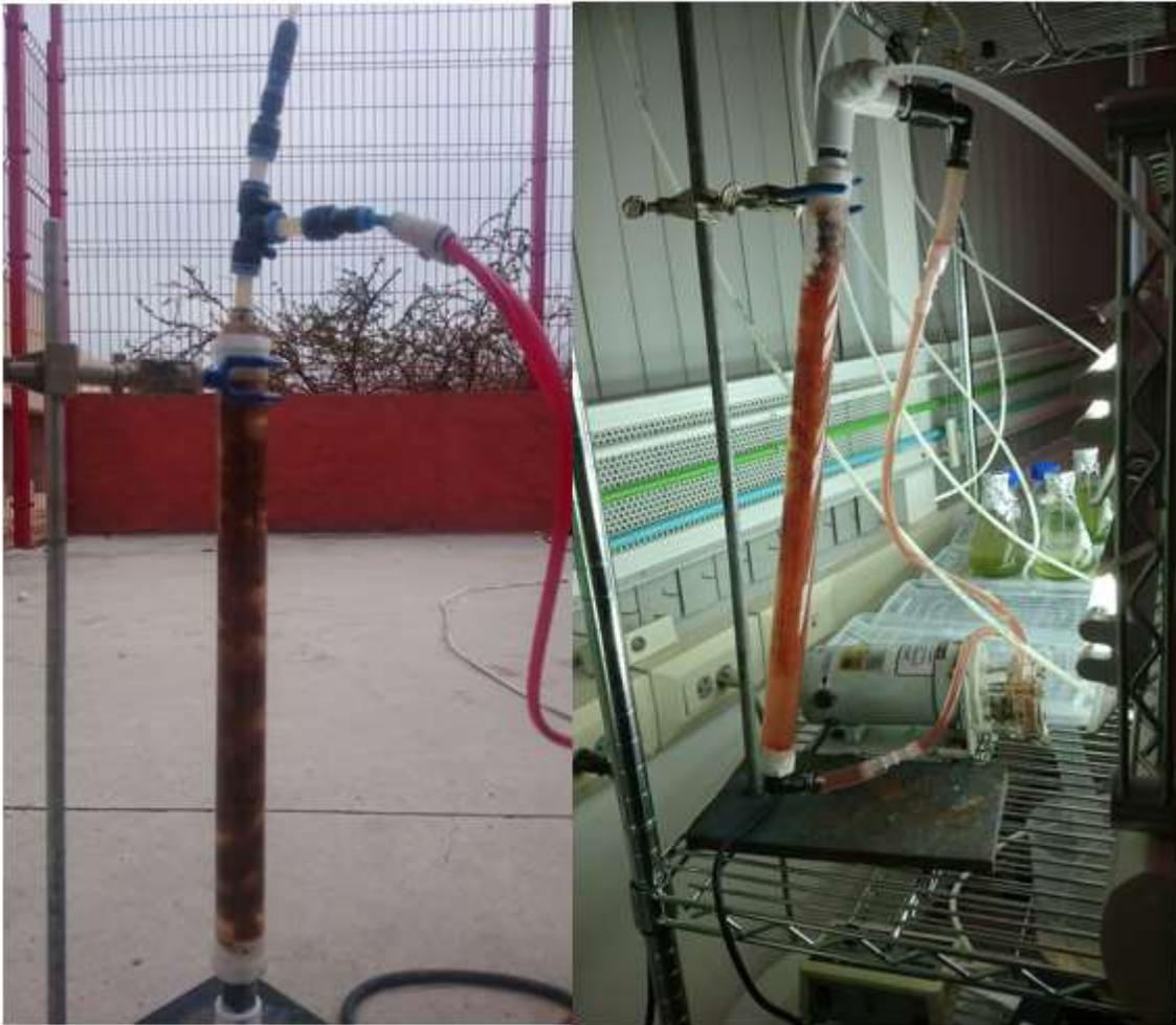
Figura 16. Fotobiorreactores tubulares. Izq. Reactor solar escala laboratorio. Der. Reactor piloto laboratorio
