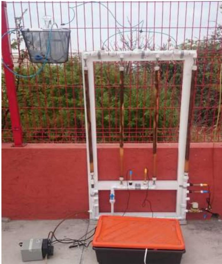
Figura 42. Fotobiorreactor piloto utilizado para evaluar el desempeño de la producción de hidrógeno en condiciones ambientales.
