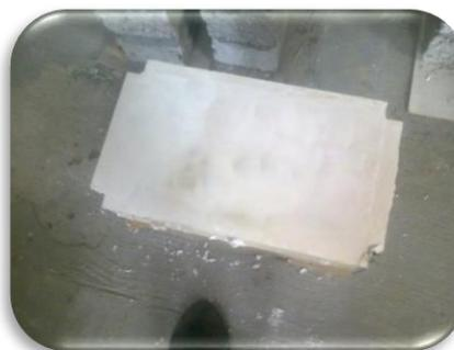
10.- Se deja secar una hora y se descimbra. Se realizan nuevamente los pasos del 4 al 9 para la cara posterior y se obtiene el cabeceo de la pieza completa.
