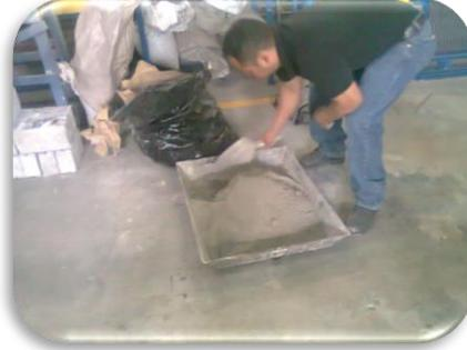
3.- Se nivelan las bases de triplay para la elaboración de las pilas que nos indica en el punto 2.8.1.1 del RCDF, "Las pilas (fig. 2.2) estarán formadas por lo menos con tres piezas sobrepuestas. La relación altura a espesor de la pila estará comprendida entre dos y cinco; las pilas se ensayarán a la edad de 28 días."
