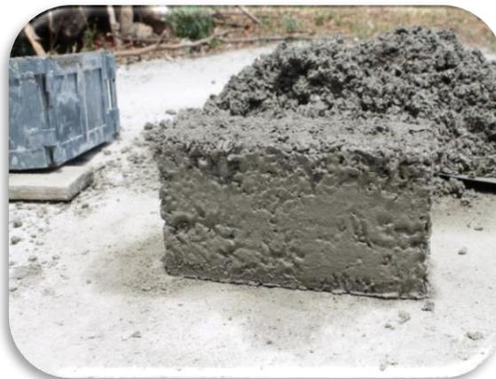
Figura 4.5 La imagen del tabicón sólido de concreto formado con la mezcla de cemento arena y PET, fabricado en capas de material: En ella se puede apreciar la formación de los estratos en el prisma sólido, debido a la formación del fenómeno conocido como “*encarpetamiento*”.
