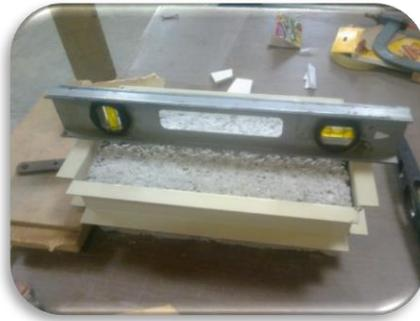
6.- Ya que tenemos nivelado el tabicón se procede a preparar la mezcla, se toma la probeta de polipropileno de 1000 ml y se mide 150 ml de agua, este caso vamos a tomar una charola de 450 ml para llenarla de cemento hydrocement, aproximadamente es la relación 1:2.
