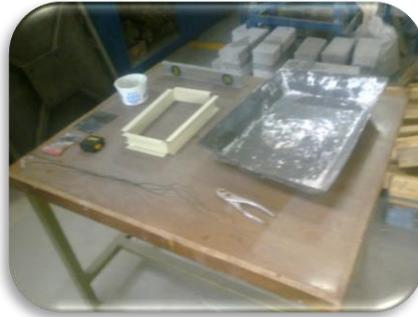
5.- Se nivela la mesa de trabajo ya que será un factor importante, nos dirá que cantidad hay que aplicar de cemento para el cabeceo a nuestro tabicón solo como primeras muestras, se coloca posteriormente el molde para el cabeceo tratando de que la distancia sea de 0.5 cm, de la parte baja del tabicón hasta alcanzar la parte más alta del perfil del molde.
