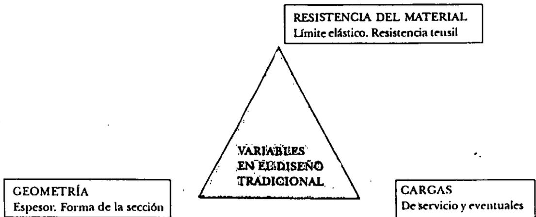
Figura . Variables del diseño de componentes estructurales por mecánica del medio continuo
