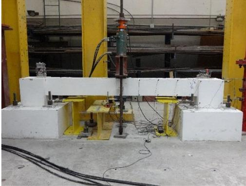
a) *Ensayo de viga a carga puntual*
