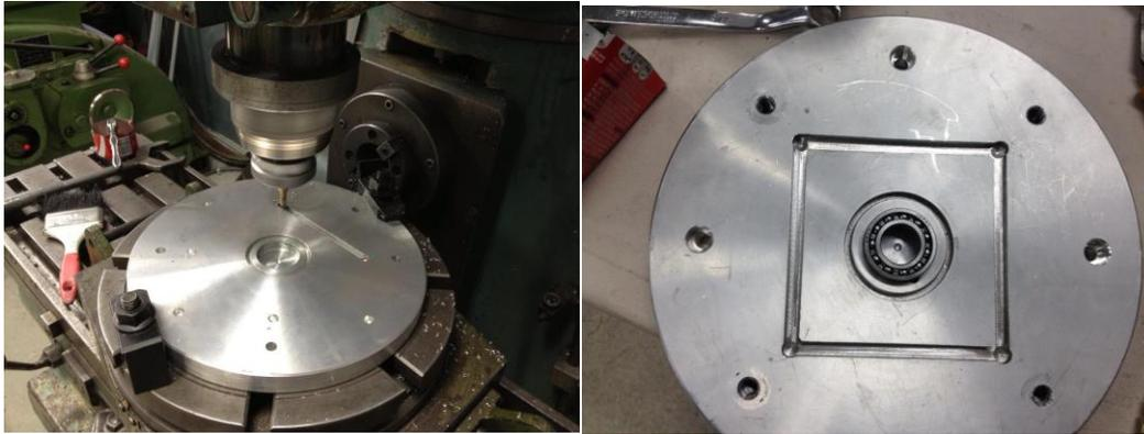
Figura 2.5. Maquinado de las bases del dispositivo experimental.
