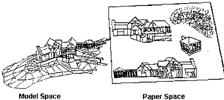
Para acceder al el *Espacio del Papel* de un dibujo se tienen las pestañas con las etiquetas *Layout 1*, *Layout 2* ... en la sección que se encuentra inmediatamente debajo del área de despliegue del proyecto y en donde por omisión está activada la pestaña *Model* (indicando que el dibujo se encuentra en el *Espacio del Modelo*). Basta dar clic sobre una de estas pestañas para trasladarse al *Espacio del Papel*. Pero bien, ¿Porqué más de una pestaña para
