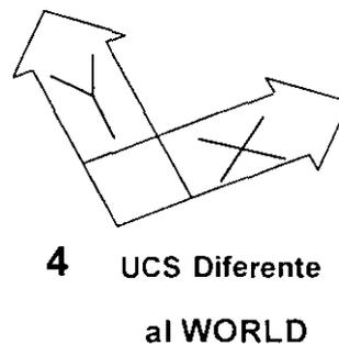
El *UCSICON* ( 1 ) Nos está indicando que se está trabajando en el Model Space, las letras X y Y, nos muestran las direcciones que tienen los ejes X y Y. La letra W nos indica que el *UCS* que está representado es el mundial (*WCS*). La cruz dentro del cuadrado nos indica que el eje positivo del eje Z está hacia adelante, (de la pantalla hacia el observador).
