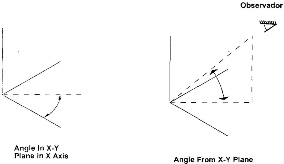
Al utilizar la opción de coordenadas X, Y y Z que representaran el punto de vista. Por ejemplo al introducir los valores -1,-1,-1, obtendremos una vista de la parte inferior izquierda del dibujo.
