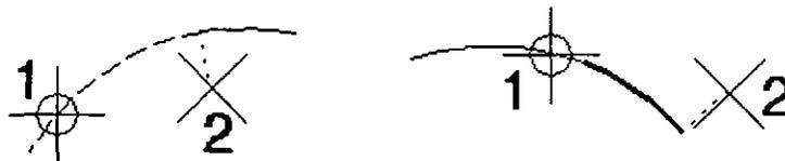
*Modificar ángulo del arco. A la izquierda, acortamiento del arco. A la derecha, alargamiento del arco.*
