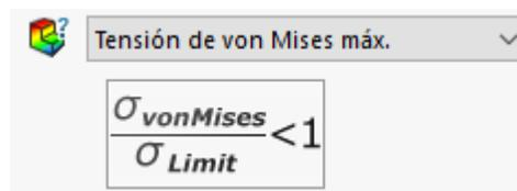
Ilustración 47: Método para calcular el Factor de Seguridad
