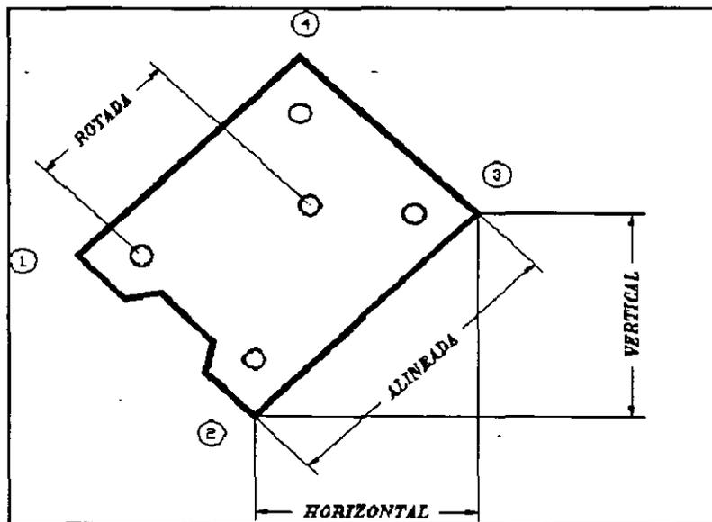
Nótese que la referencia para la cota horizontal (puntos 2 y 3) es la misma que para las cotas vertical y alineada. La cota rotada, mide una longitud con una orientación diferente a la horizontal, vertical y alineada; en este ejemplo, la orientación de la línea que va del punto 1 al punto 4 de la pieza.
