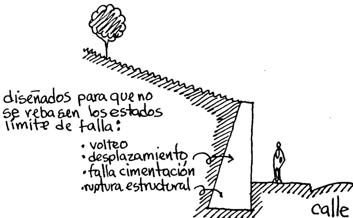
**Art. 230.** Como parte del estudio de mecánica de suelos, se deberá fijar el procedimiento constructivo de las cimentaciones, excavaciones y muros de contención que asegure el cumplimiento de las hipótesis de diseño y garantice la seguridad durante y después de la edificación. Dicho procedimiento deberá ser tal que se eviten daños a las estructuras e instalaciones vecinas por vibraciones o desplazamiento vertical u horizontal del suelo.
