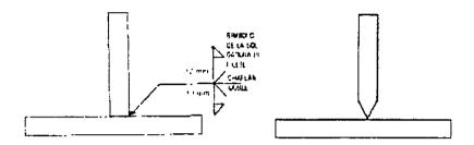
A continuación está el símbolo de soldadura de filete en ambos lados de la línea de referencia. Pero antes de poder aplicar una soldadura de filete, debe haber una superficie vertical. Por tanto, se rellena el chaflán con soldadura como se ve en la siguiente figura.
