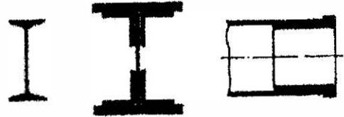
**Figura 8.6 Secciones de espesor reducido.**
