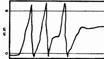
c) Obstrucción en la pluma o varillas del flotador (recuperable).
