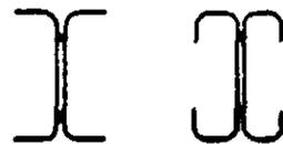
c) Secciones "I" formadas por dos canales
