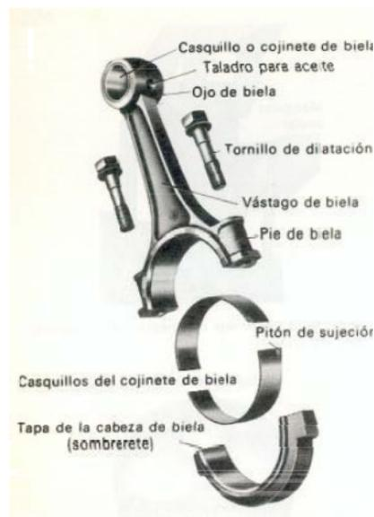
Figura 3.5 Componentes de la biela [Gerschler, 1985]
