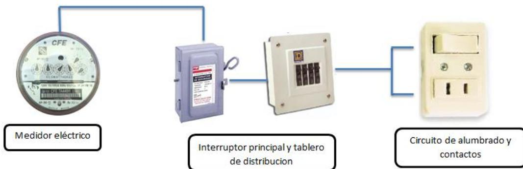
Figura 3. Instalación eléctrica monofásica
