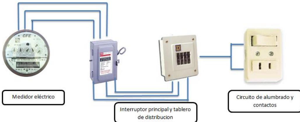
Figura 6. Instalación eléctrica trifásica con 1 solo medidor
