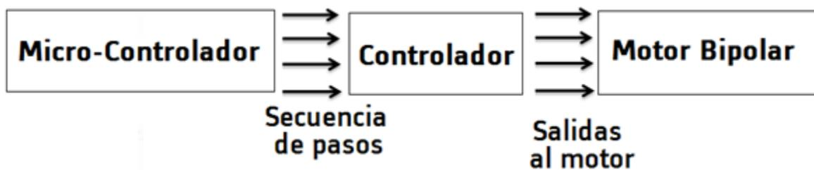
Figura 34. Principio de funcionamiento del motor bipolar
