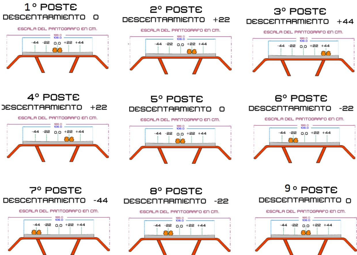
Figura 24. Deslizamiento de los hilos de contacto en la pletina del pantógrafo
