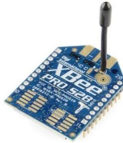
Fig. 2.11 Circuito de transmisión inalámbrica XBee.
