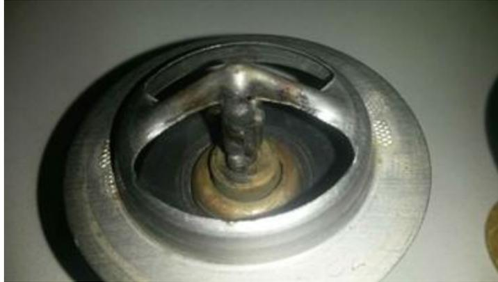
Figura 6. Termostato bloqueado en una posición abierta<sup>25</sup>.
