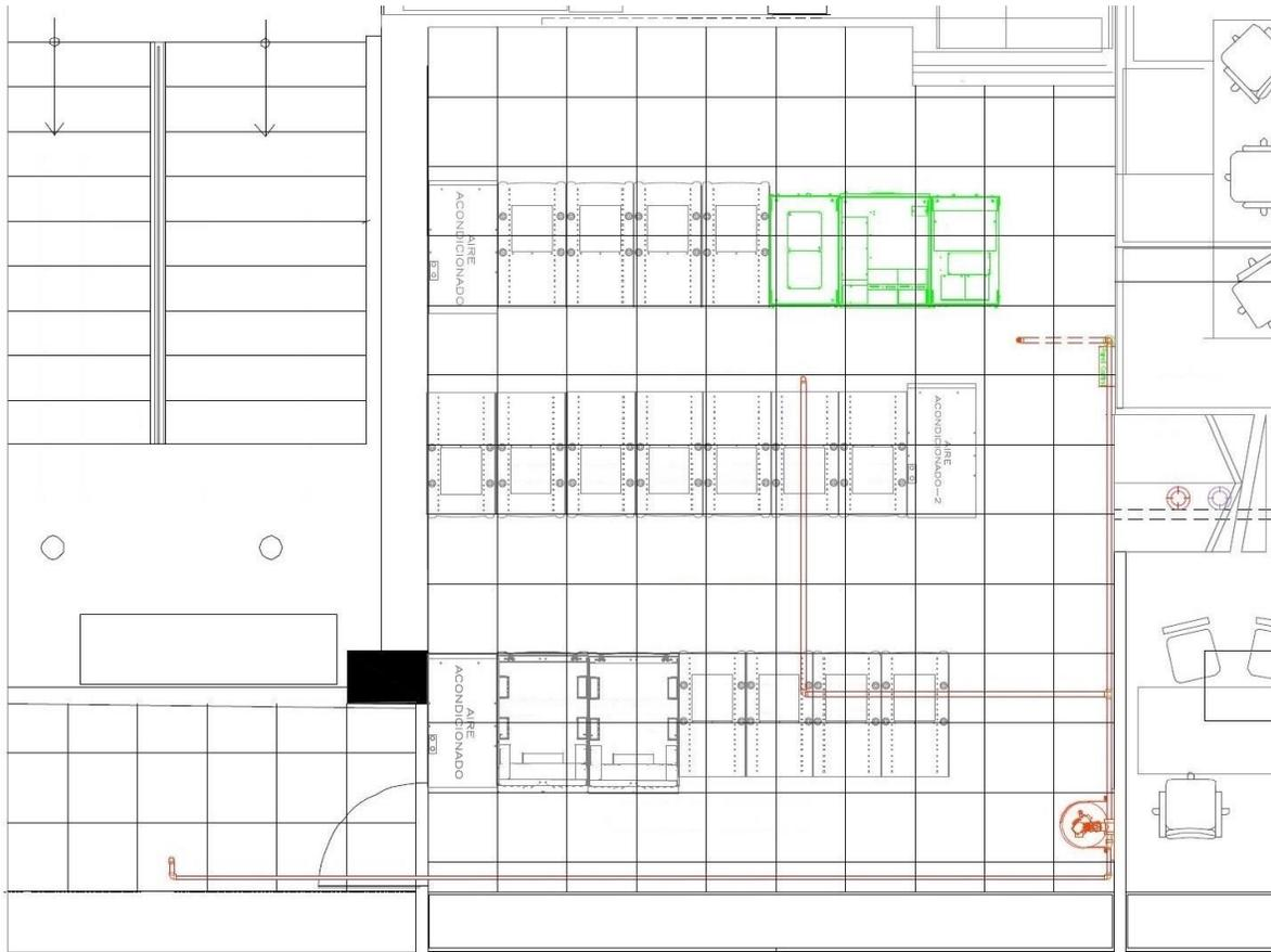
6.- Instalación de la escalerilla destinada a contener el cableado de datos y la ubicación de los racks de comunicaciones y los utilizados para equipo de procesamiento y almacenamiento de datos.
