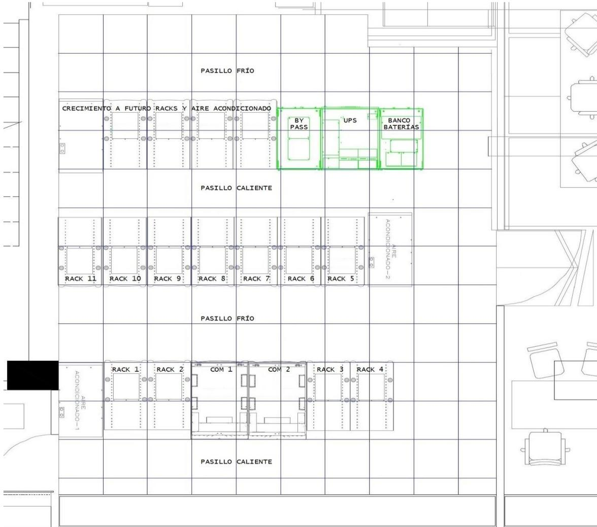
**Figura 11.** Sembrado de equipo planificado por la **propuesta 2** para el **Centro de Datos.**
