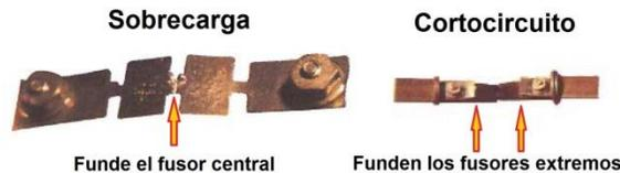
Imagen 59. Operación del eslabón-fusible. Fuente Mercury y Karp™.
