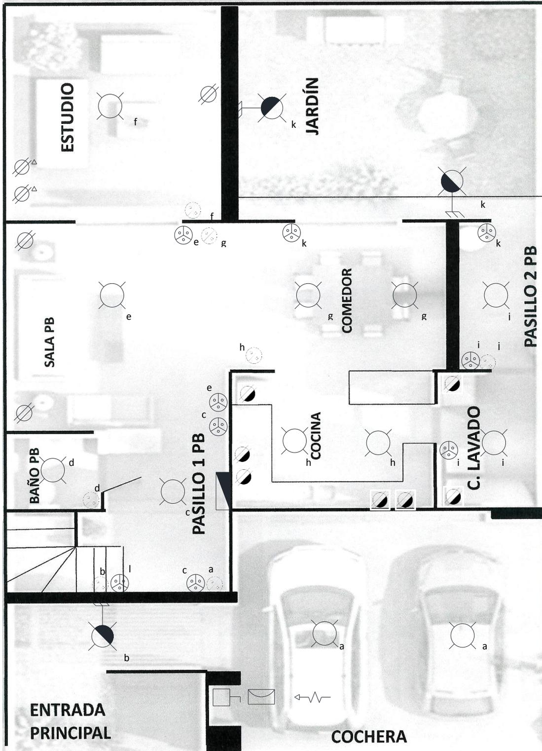
Imagen 143. Plano de obra civil planta baja con contactos y luminarios.
