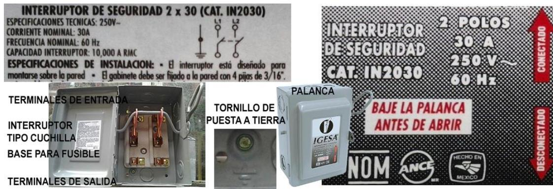
Imagen 93. Interruptor de seguridad con base para fusible (tipo cartucho clase H y K1).
