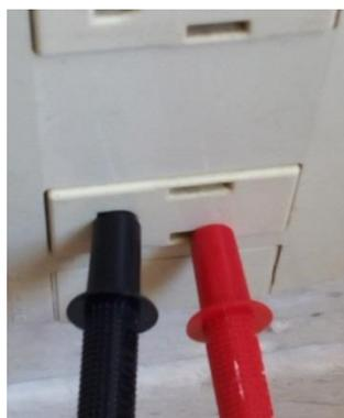
Imagen 122. Prueba de falla a tierra en contacto.
