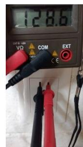
**Imagen 126. Medición de voltaje.**
