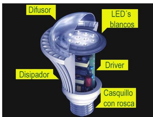
Imagen 83. Partes de una lámpara LED
