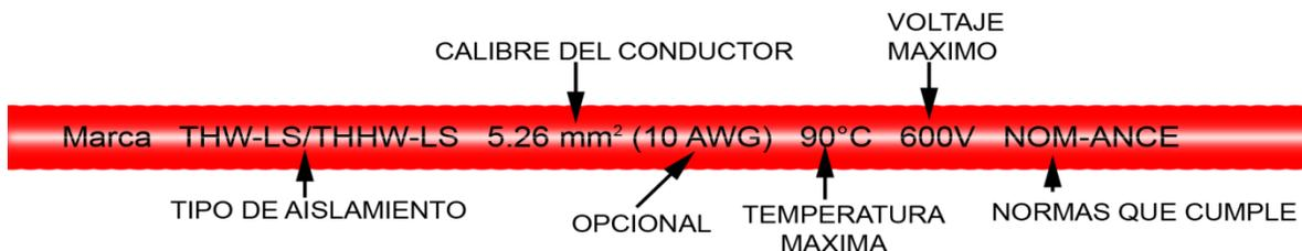
Imagen 26. Impresión en el exterior de un conductor.
