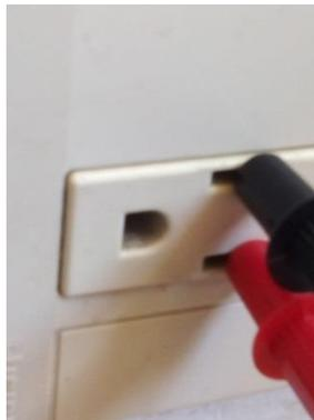
**Imagen 123. Prueba de cortocircuito en contacto.**
