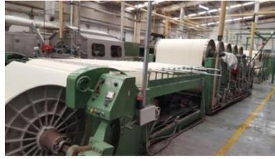
**Ilustración 5. Máquina engomadora**
