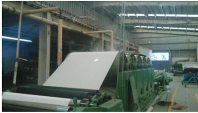
**Ilustración 6. Proceso de engomado**
