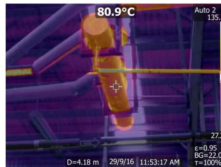
**Ilustración 24** Termografía del aislante
