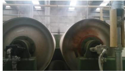
**Ilustración 7. Inyección de vapor**
