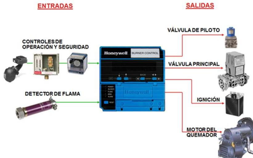
**Ilustración 31 de Seguridad de Llama y relación Aire/Combustión**
