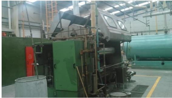
Ilustración 11 Jigger sin mantenimiento
