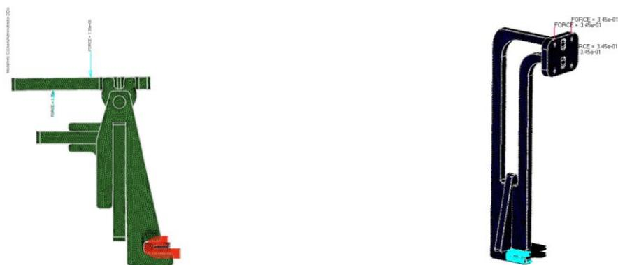
*Figura 24. Muestra el módulo de horizonte y del cenit mallados. Se aprecian las fuerzas actuantes del modelo, así como el encastre en la parte inferior representado en triángulos de color.*
