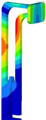
Figura 30. Frecuencia Natural para el Modo 6, con valor de 1.06 MHz.
