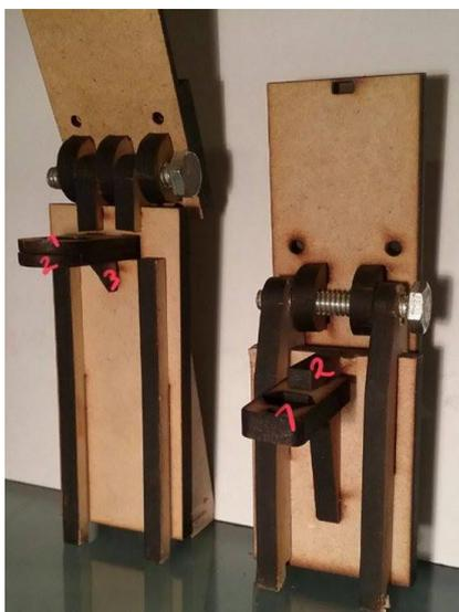
*Figura 19. A la izquierda el “Diseño Radial” y a la derecha el “Diseño Radial Sintetizado” se aprecia el cambio en el ensamble de dicho conjunto de piezas explicadas anteriormente.*
