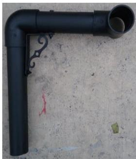
*Figura 64. Soporte de PVC de la estación, pintado de negro mate para que ningún haz de luz incida sobre él y lo refleja alterando las imágenes de las cámaras dentro del planetario.*
