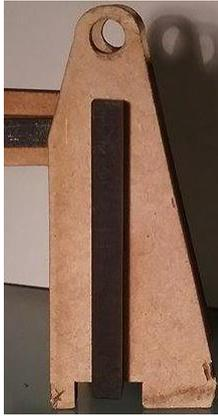
Figura 15. Se logra ver en comparación con la imagen anterior que esas piezas superior e inferior se hacen una cumpliendo con la misma función dándole mayor rigidez al módulo ya que no está suelta ninguna pieza, siendo ahora dos piezas por módulo (en vez de 4 ahora hay 2).
