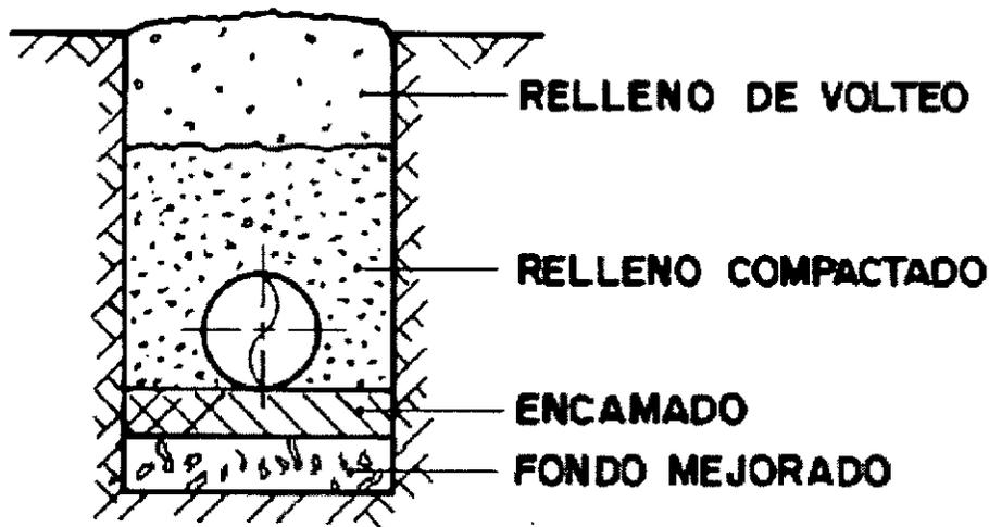
FIGURA 15. SECCIÓN TRANSVERSAL TIPO CON RELLENOS
