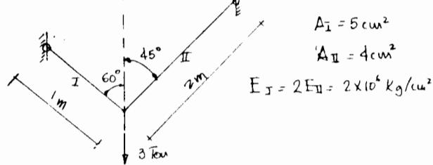
Solución: Por  $\sum F_y = 0$   $T_1 \cos 60^\circ + T_2 \cos 45^\circ = 3$  (1)
