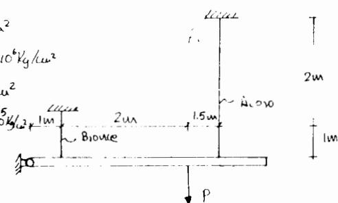
$$\text{Solución: Por } \sum M_A = 0 \quad (2) \quad 3P = T_B + 4.5 T_A \quad (1)$$
