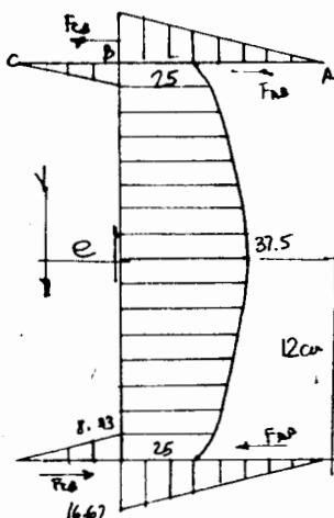
Problema Una viga de sección transversal en cajón como la mostrada soporta una carga uniformemente distribuida de 200Kg/m y una fuerza concentrada P. Considerando únicamente la acción de la fuerza constante, determine el máximo valor de P que puede ser aplicada si el esfuerzo constante permisible  $Z_p = 30 \text{ Kg/cm}$
