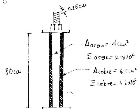
**Solución:**  $\Delta l = \frac{0.25}{2} = \Delta l_{\text{tubo}}$   $T_{\text{torzillo}} = C_{\text{tubo}} = P$
