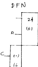
Problema Encuentre el diámetro de las secciones transversales I y II del sistema mostrado para que resista las cargas aplicadas P satisfactoriamente.
