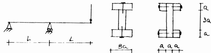
Solución: Se necesitan n clavos en cada hilera, siendo  $n = \frac{L}{S}$ ;  $S = \frac{F'}{q}$ ;  $n = \frac{Lq}{F'} = \frac{Lq}{F'Ib} = KQ$
