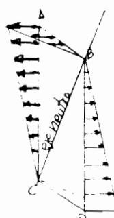
Problema En una presa de desviación una viga que forma parte de una compuerta soporta una carga hidrostática como se muestra en la figura. Obtener el esfuerzo en el punto D de la sección a-a debido al momento flexionante.
