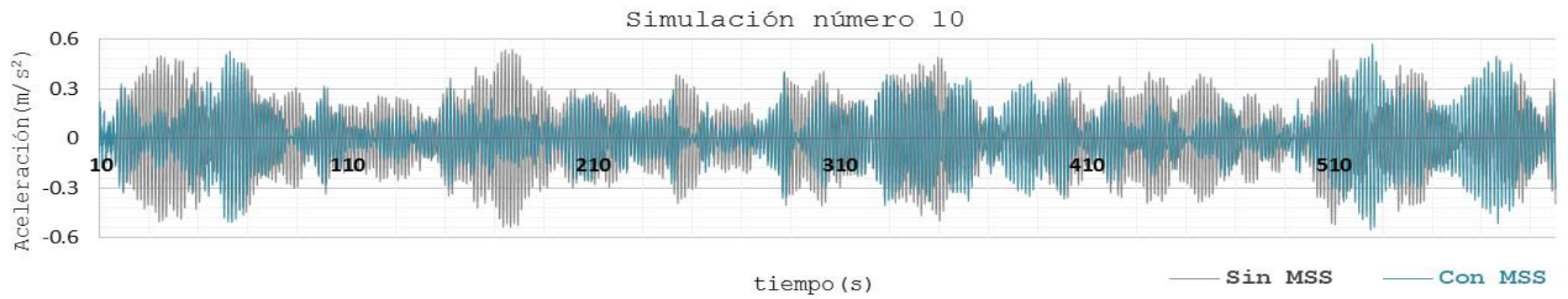
Figura 30. Historia en el tiempo de la aceleración en el nodo 392, debida a la décima simulación.
