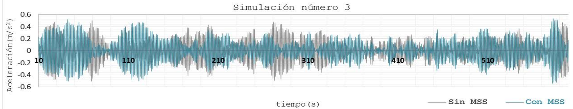
Figura 23. Historia en el tiempo de la aceleración en el nodo 392, debida a la tercera simulación.
