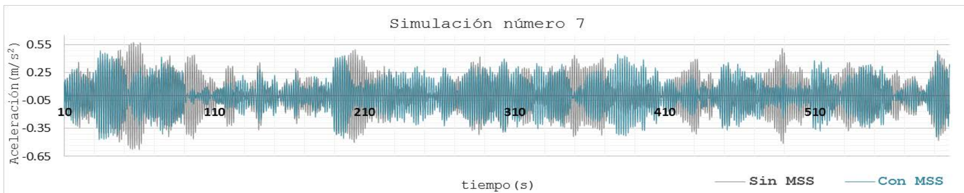
Figura 27. Historia en el tiempo de la aceleración en el nodo 392, debida a la séptima simulación.
