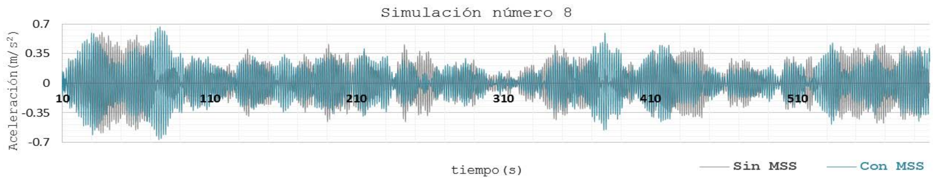
Figura 28. Historia en el tiempo de la aceleración en el nodo 392, debida a la octava simulación.
