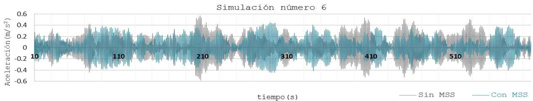
Figura 26. Historia en el tiempo de la aceleración en el nodo 392, debida a la sexta simulación.
