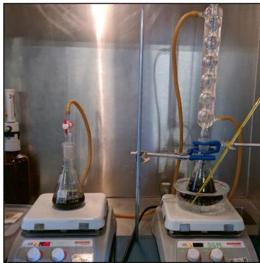
**Figura 5.5 Arreglo para el pretratamiento con organosolv.**
