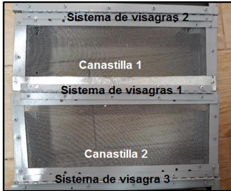
Figura 4.34 Canastilla recolectora de solidos
