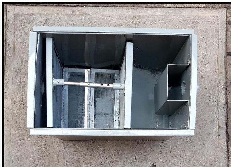
Figura 4.45 Vista superior del mecanismo resultante, al interior de la trampa de grasa
