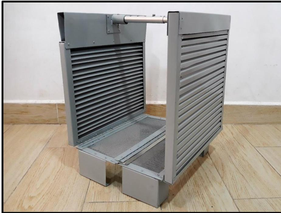
Figura 4.44 Mecanismo interno de la trampa de grasa
