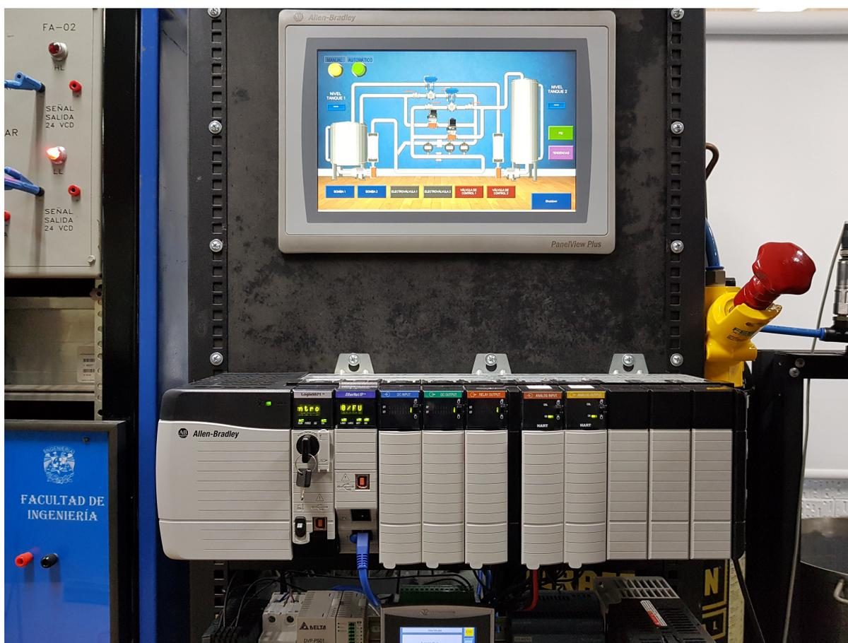
Figura 5.2. ControlLogix 5571
